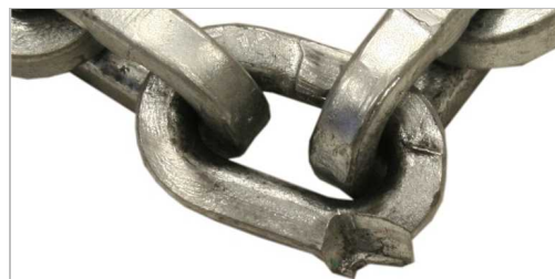
Mechanicky poškozený článek řetězu.
